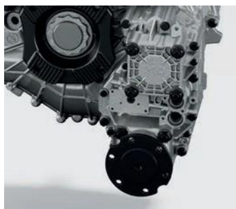
Exemplu de priză de putere dependentă de cutie de viteze cu flanșă, poziție de instalare aprox. ora 5:00
